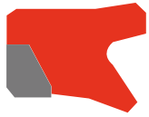
STA110 Nutring-Stangen- dichtung mit inte- griertem schrägen Stützring
