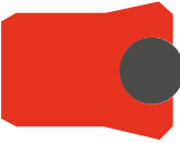
STA190 Symmetrische Nutring- Stangendichtung mit unterstützen- dem O-Ring
